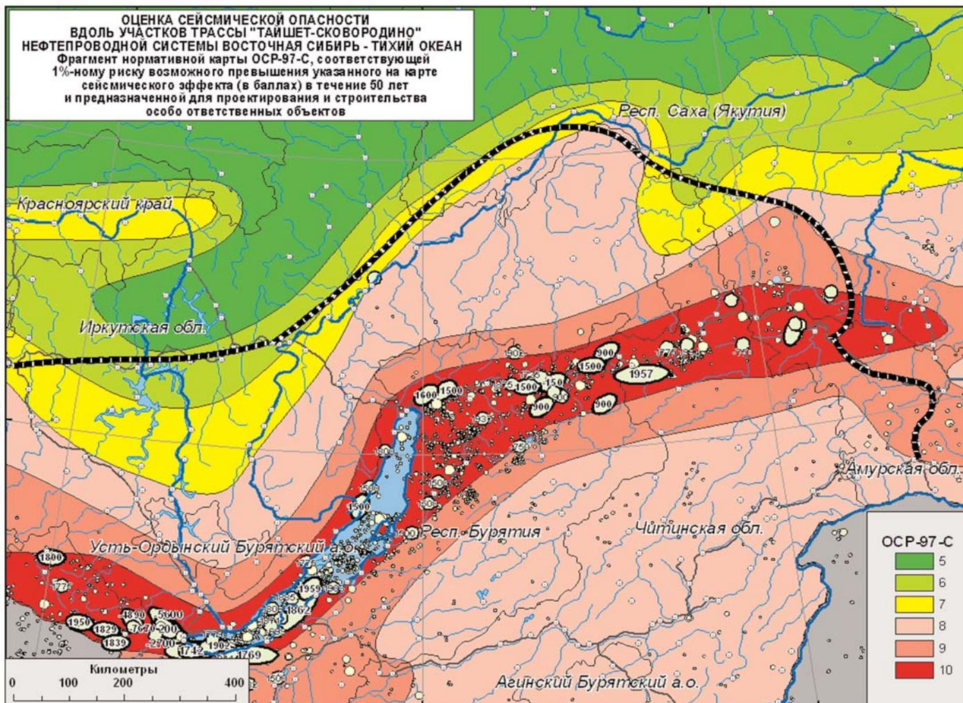
Новый вариант трассы нефтепровода ВСТО. Цифрами указаны годы наиболее сильных землетрясений прошлых лет, разными цветами - зоны балльности. New Option of the "Eastern Siberia – Pacific Ocean" Oil-Pipe Line. Figure indicate the fragment of GSZ-97C map with 1% risk and most serious earthquakes. Different colors show the different seismic intensity zones.
