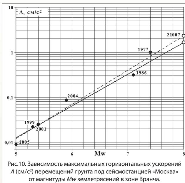
Рис.10. Зависимость максимальных горизонтальных ускорений  $A$  (см/с<sup>2</sup>) перемещений грунта под сейсмостанцией «Москва» от магнитуды  $M_w$  землетрясений в зоне Вранча.
