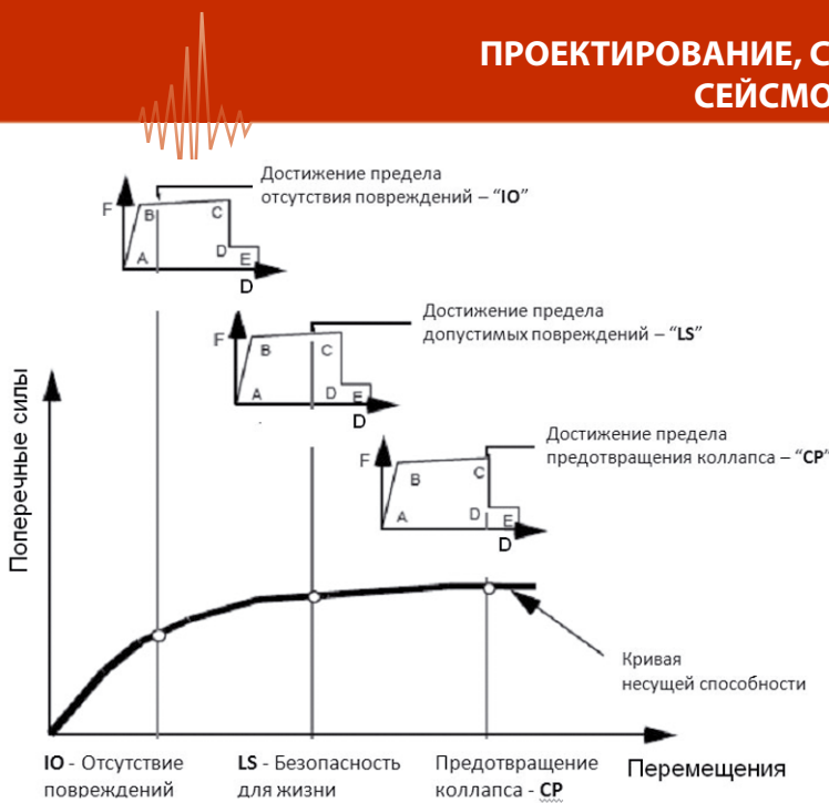
Рис.1. Соотношения между обобщенными силами и перемещениями для различных эксплуатационных уровней, соответствующих пластической кривой несущей способности сооружения
