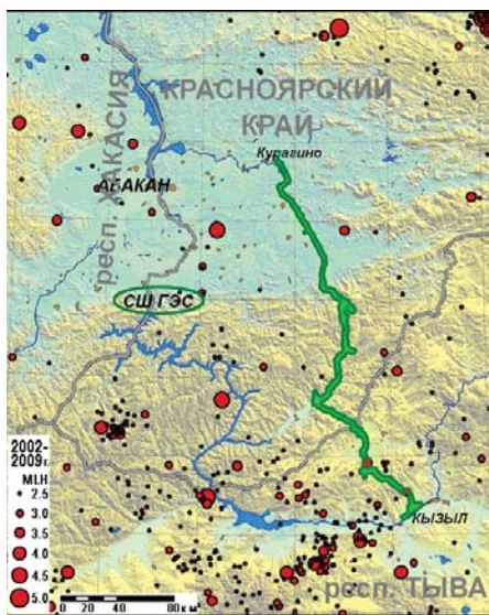
Рис. 11. Фрагмент карты эпицентров землетрясений, зарегистрированных за период 2002–2009 гг. Показана трасса железной дороги Курагино — Кызыл и оконтурено местоположение Саяно-Шушенской ГЭС
