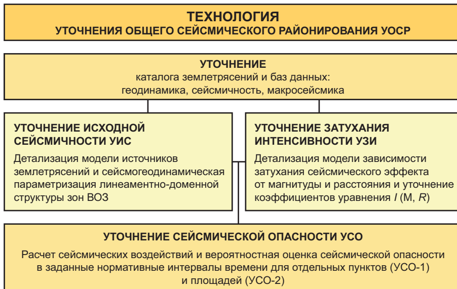
Рис. 8. Блок-схема технологии детализации и актуализации карт ОСР-97
