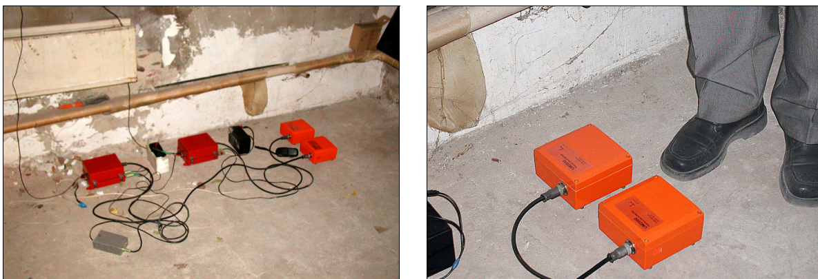
Рис. 4.2.3. Калибровочная запись параллельно установленными датчиками.
