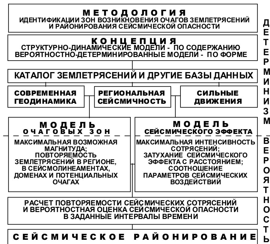
Рис. 2. Методология сейсмического районирования [39, 46]. На основе трех блоков банка данных (геодинамика, сейсмичность и сильные движения грунта) формируются две модели – очаговых зон (МОЗ) и сейсмического эффекта (МСЭ), на основе которых ведется расчет сейсмической опасности и составляются карты сейсмического районирования.
