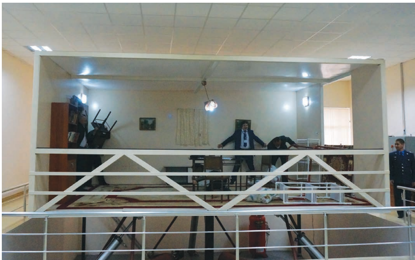
Рис. 7. Имитация землетрясения на вибростоле
