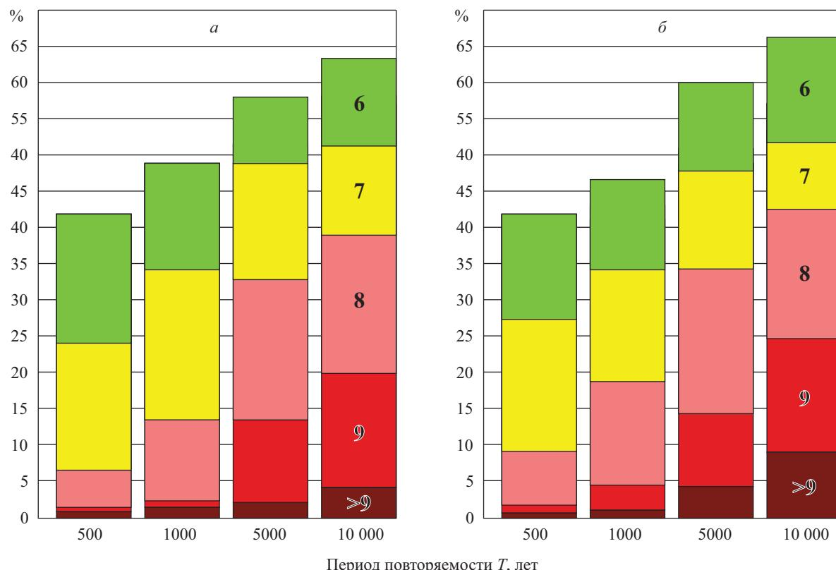
**Рис. 10.** Сравнительный размер площадей зон разной сейсмической интенсивности (6–9 и  $>9$  баллов) по картам ОСР-2012 (а) и ОСР-97 (б) для разных периодов повторяемости по отношению ко всей территории России (см. табл. 2), %
