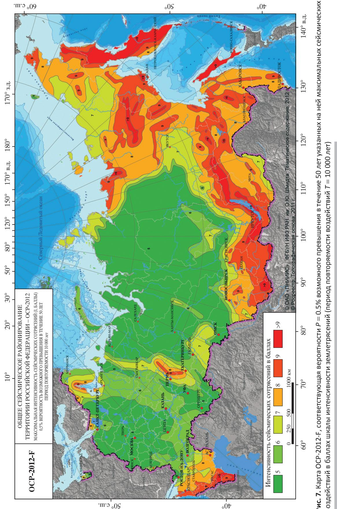
**Рис. 7.** Карта ОСР-2012-Ф, соответствующая вероятности  $P = 0.5\%$  возможного превышения в течение 50 лет указанных на ней максимальных сейсмических воздействий в баллах шкалы интенсивности землетрясений (период повторяемости воздействий  $T = 10\,000$  лет)
